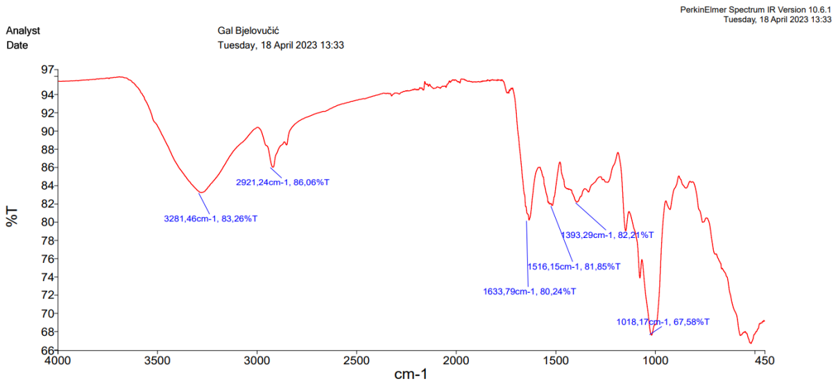
Slika 4-43: Spekter ATR-FTIR vzorca PD_LA_3.
