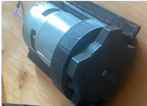
Slika 2.11: Motor DC RS-755 [Lastni vir]
