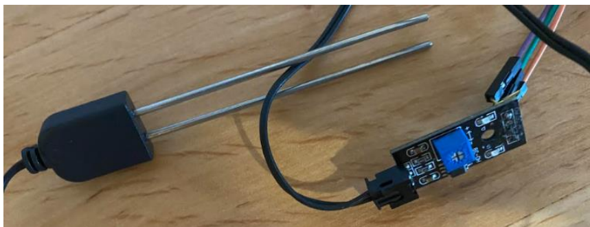
Slika 2.7: Senzor vlage zemlje [Lastni vir]
