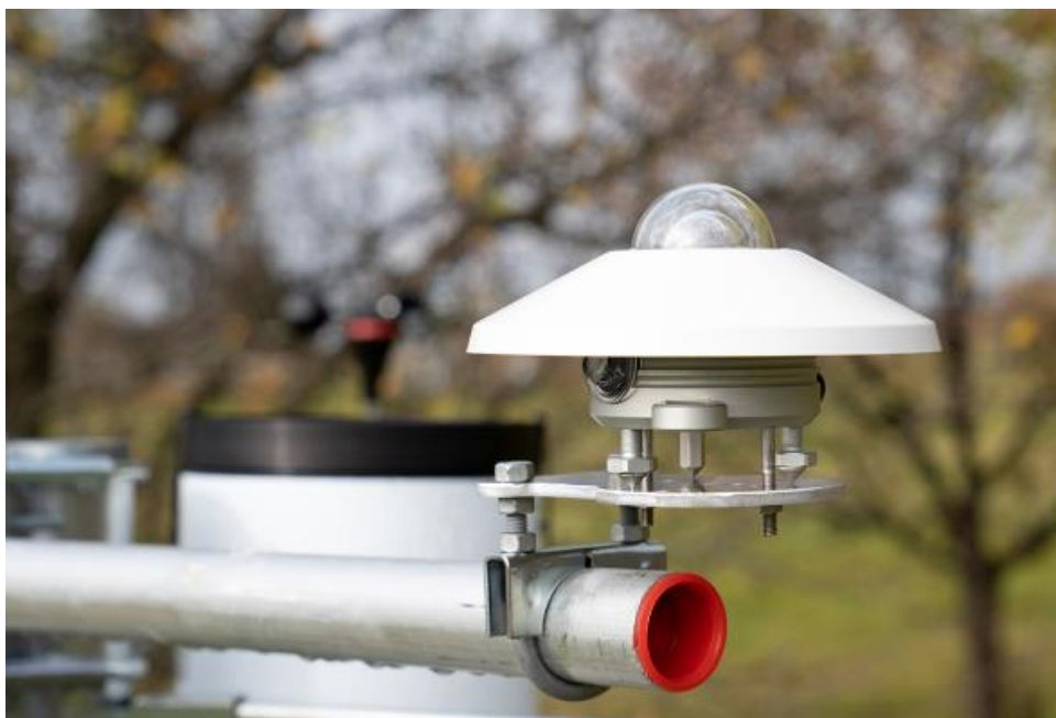
Slika 2.4: Primer sodobnega piranometra [9]
