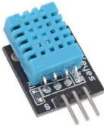
Slika 3.4: Senzor za merjenje temperature in vlažnosti DHT11 [17]
