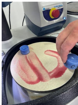
Slika 4.21: Pričetek poliranja metalografskega obrusa [9]
