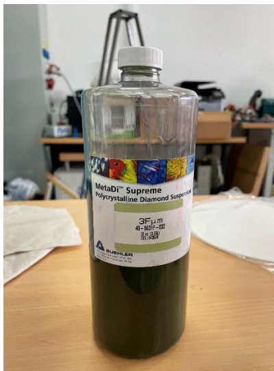
Slika 4.20: Diamantna polirna tekočina za poliranje metalografski obrusov [9]
