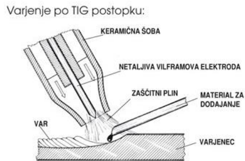
Slika 3.1: Shematski prikaz varjenja v zaščiti plina argona [1]
