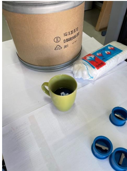
Slika 4.14: Priprava dvokomponentne mešanice za zalivanje vzorcev [9]
