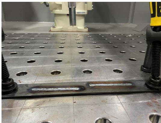
Slika 4.4: Izvedba navarov na ravno ploščo [9]
