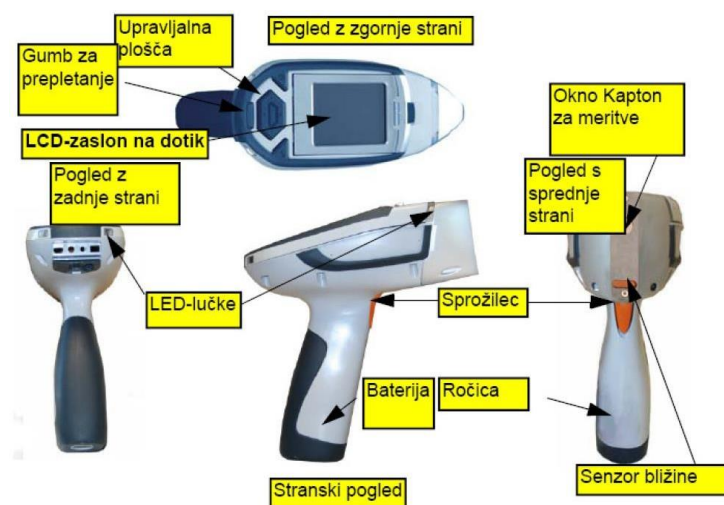
Slika 4.6: Shematski prikaz spektralnega analizatorja NITON GOLD+ [6]
