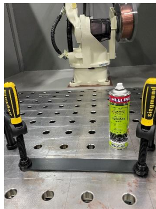
Slika 4.2: Robotska celica in priprava materiala za varjenje - čiščenje [9]
