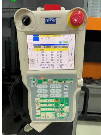
Slika 4.1: Upravljalna prenosna enota robota [9]
