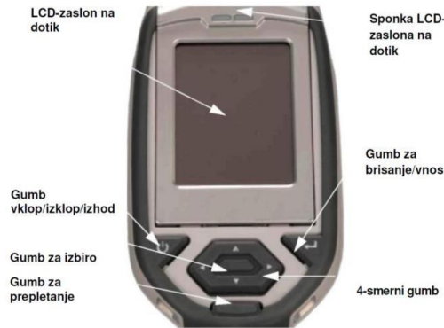
Slika 4.7: Funkcijski deli zgornjega dela naprave NITON GOLD+ [6]
