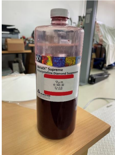
Slika 4.19: Polirna tekočina za poliranje metalografskih obrusov [9]
