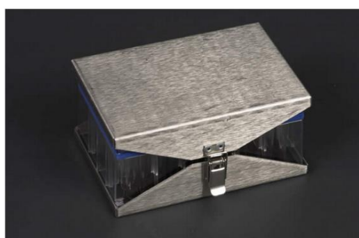
Figura A3. Izquierda: colocación de placa de detección sobre la placa con suelos y sustratos, con el sistema de Microresp™ que permite el paso de gases. Derecha: Sistema de sellado de Microresp™ (Campbell et al., 2003).
