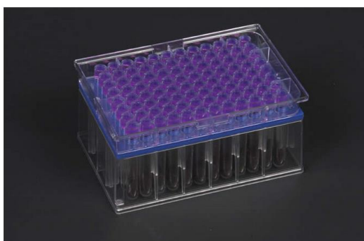
Figura A3. Izquierda: colocación de placa de detección sobre la placa con suelos y sustratos, con el sistema de Microresp™ que permite el paso de gases. Derecha: Sistema de sellado de Microresp™ (Campbell et al., 2003).
