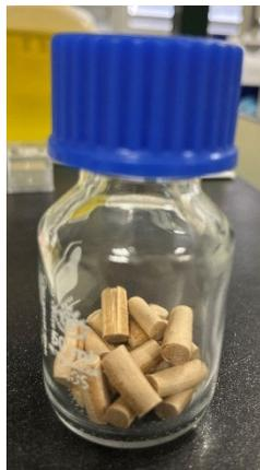
**Figura 9:** Boquillas de celulosa estériles
