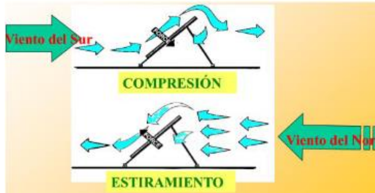
Ilustración 6 La fuerza del viento sobre una superficie inclinada (Arrieta Morelo & Puello Bravo, 2018, fig. 34)
