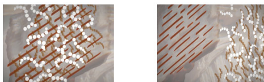
Figura 5. Proceso de separación de lignina y fibras en el digestor.
