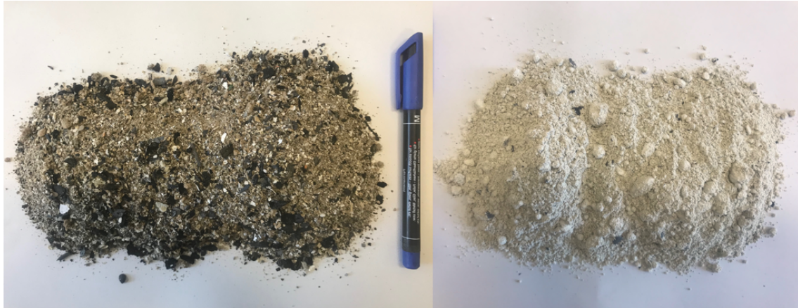
Figure 7.3: Makroskopische Unterschiede zwischen der Kesselasche (links) und der Elektrofilterasche (rechts).
