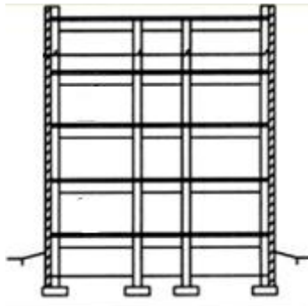
Рисунок 1. Каркасна схема багатоповерхової будівлі[2]
