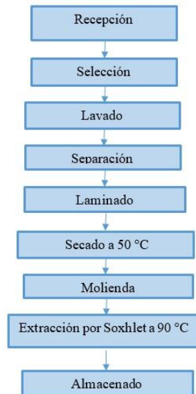
Figura 8. Diagrama de flujo del proceso. Método de extracción por solventes orgánicos
