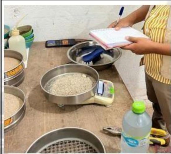
Fotos nº 05-06: En las imágenes podemos observar la realización del ensayo el peso específico
