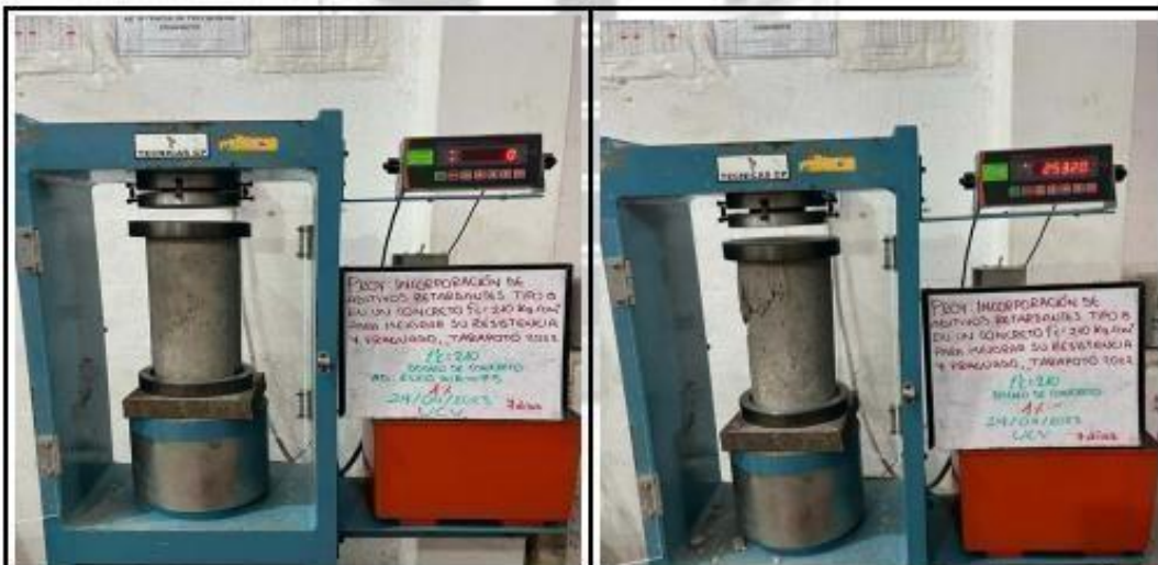
Fotos nº 75-76: En las imágenes podemos observar la resistencia a la compresión axial de los testigos de concreto
