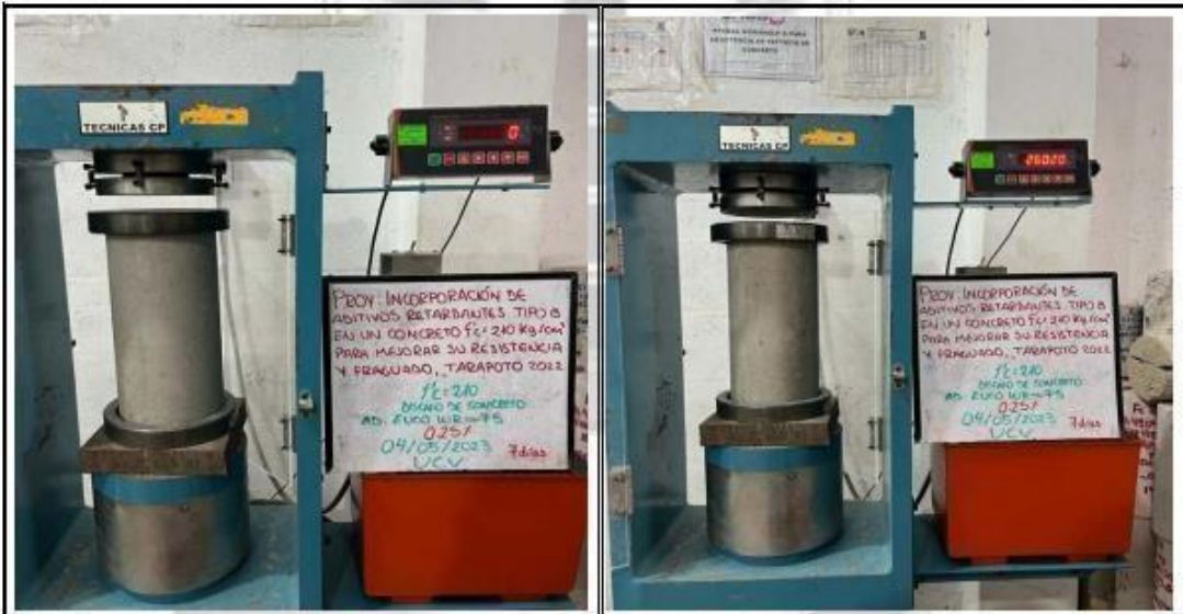
Fotos nº 35-36: En las imágenes podemos observar la resistencia a la compresión axial de los testigos de concreto
