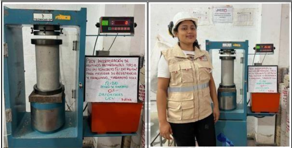
Fotos nº 17-18: En las imágenes podemos observar la resistencia a la compresión axial de los testigos de concreto
