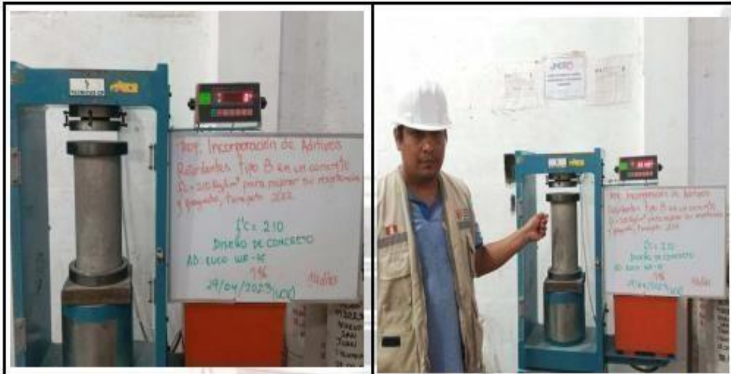
Fotos nº 77-78: En las imágenes podemos observar la resistencia a la compresión axial de los testigos de concreto
