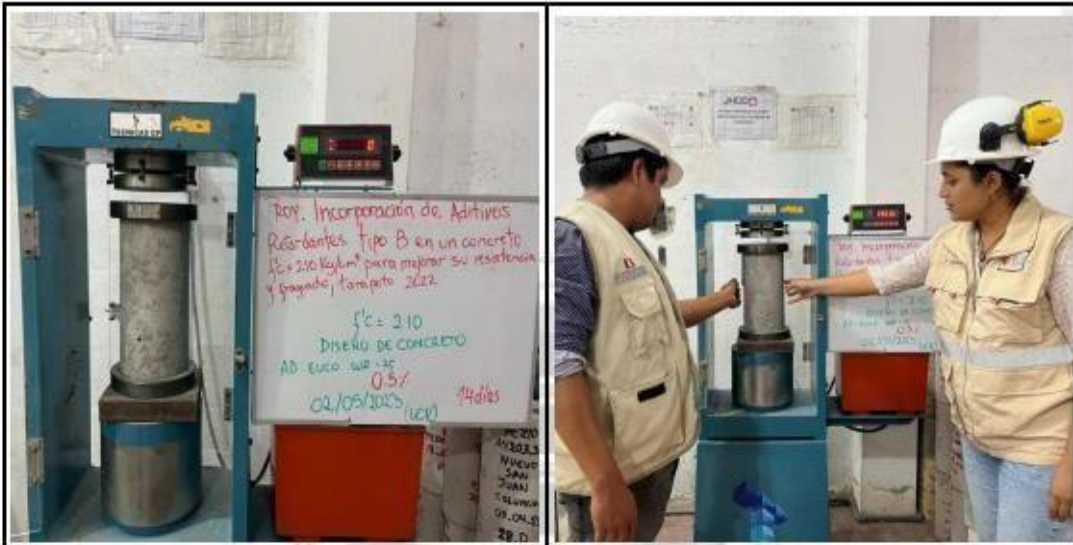
Fotos nº 61-62: En las imágenes podemos observar la resistencia a la compresión axial de los testigos de concreto
