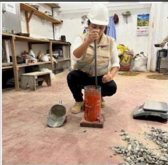
Fotos nº 07-08: En las imágenes podemos observar realización del ensayo de peso unitario.
