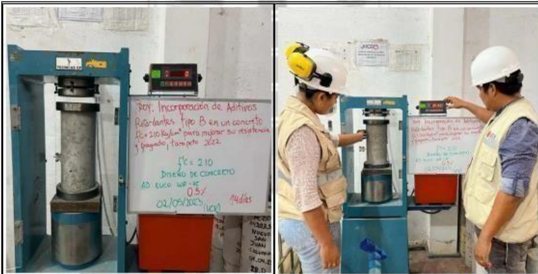
Fotos nº 63-64: En las imágenes podemos observar la resistencia a la compresión axial de los testigos de concreto
