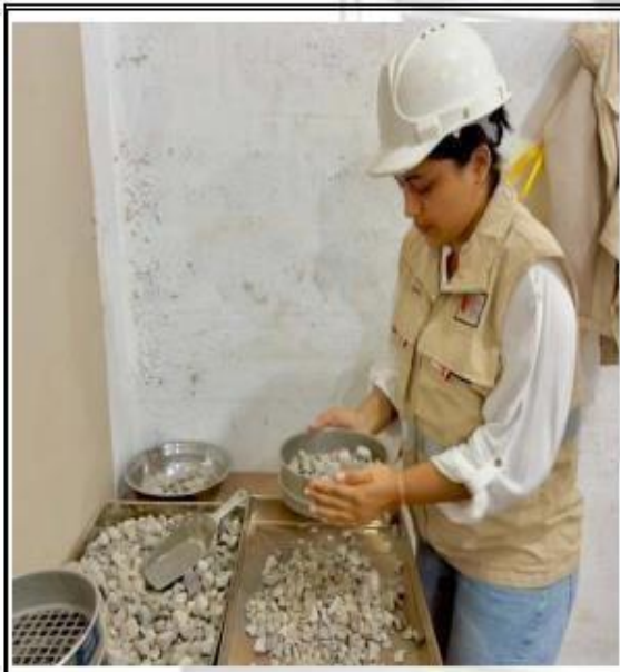
Fotos nº 03-04: En las imágenes se puede apreciar el ensayo de análisis granulométricos.
