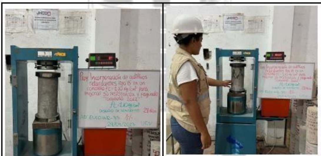
Fotos nº 83-84: En las imágenes podemos observar la resistencia a la compresión axial de los testigos de concreto
