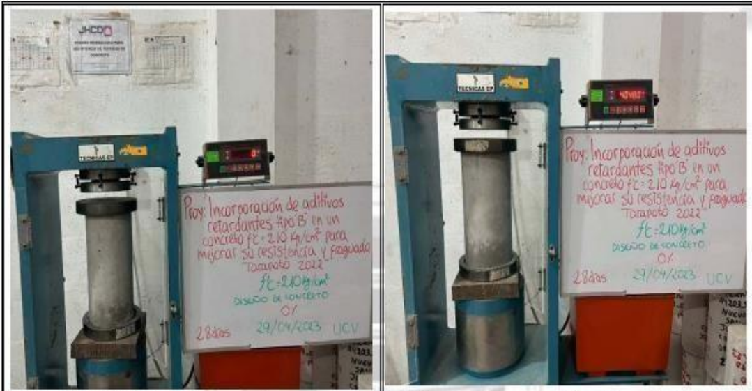
Fotos nº 33-34: En las imágenes podemos observar la resistencia a la compresión axial de los testigos de concreto
