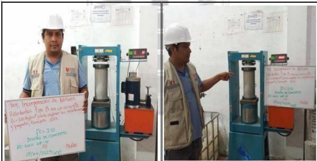
Fotos nº 23-24: En las imágenes podemos observar la resistencia a la compresión axial de los testigos de concreto
