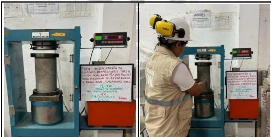
Fotos nº 71-72: En las imágenes podemos observar la resistencia a la compresión axial de los testigos de concreto
