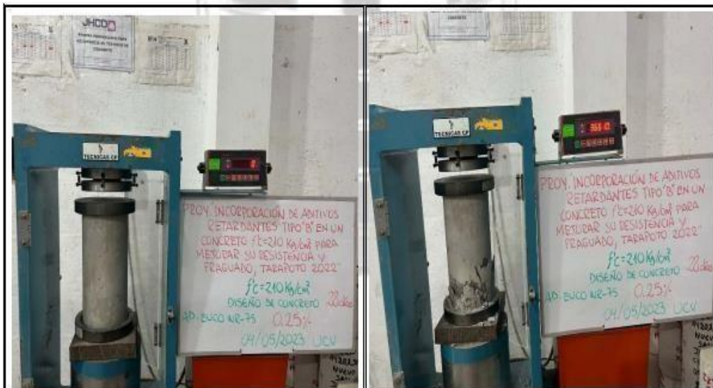
Fotos nº 51-52: En las imágenes podemos observar la resistencia a la compresión axial de los testigos de concreto
