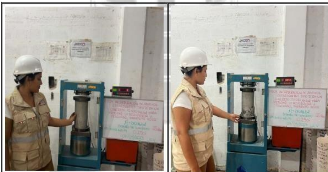
Fotos nº 47-48: En las imágenes podemos observar la resistencia a la compresión axial de los testigos de concreto
