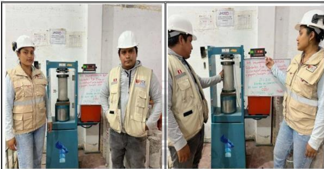
Fotos nº 41-42: En las imágenes podemos observar la resistencia a la compresión axial de los testigos de concreto
