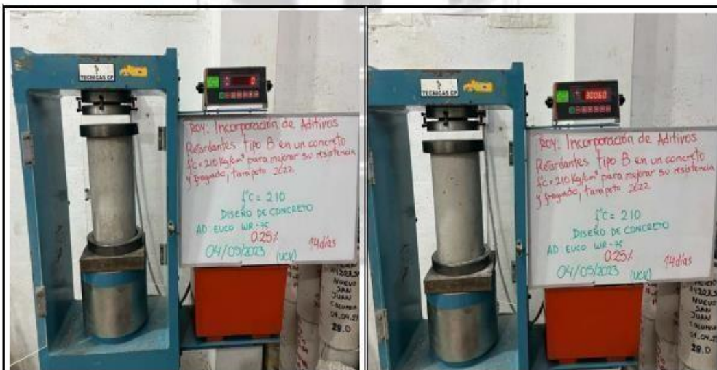
Fotos nº 43-44: En las imágenes podemos observar la resistencia a la compresión axial de los testigos de concreto
