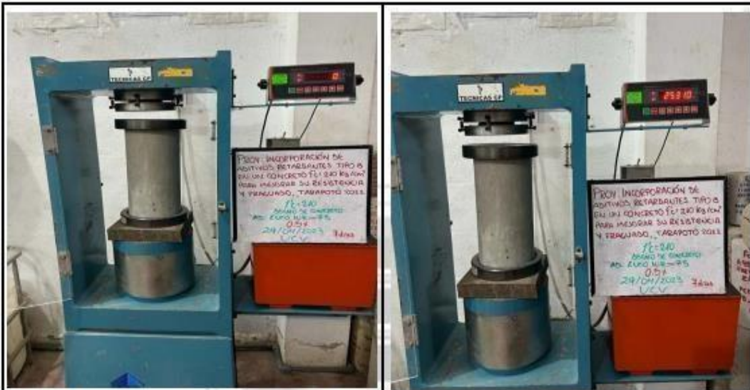
Fotos nº 57-58: En las imágenes podemos observar la resistencia a la compresión axial de los testigos de concreto
