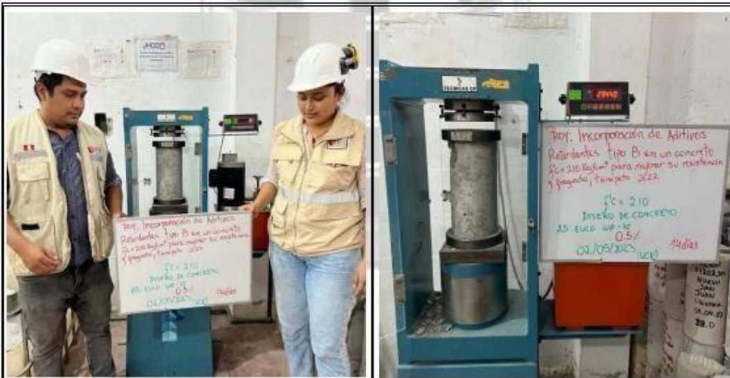
Fotos nº 59-60: En las imágenes podemos observar la resistencia a la compresión axial de los testigos de concreto
