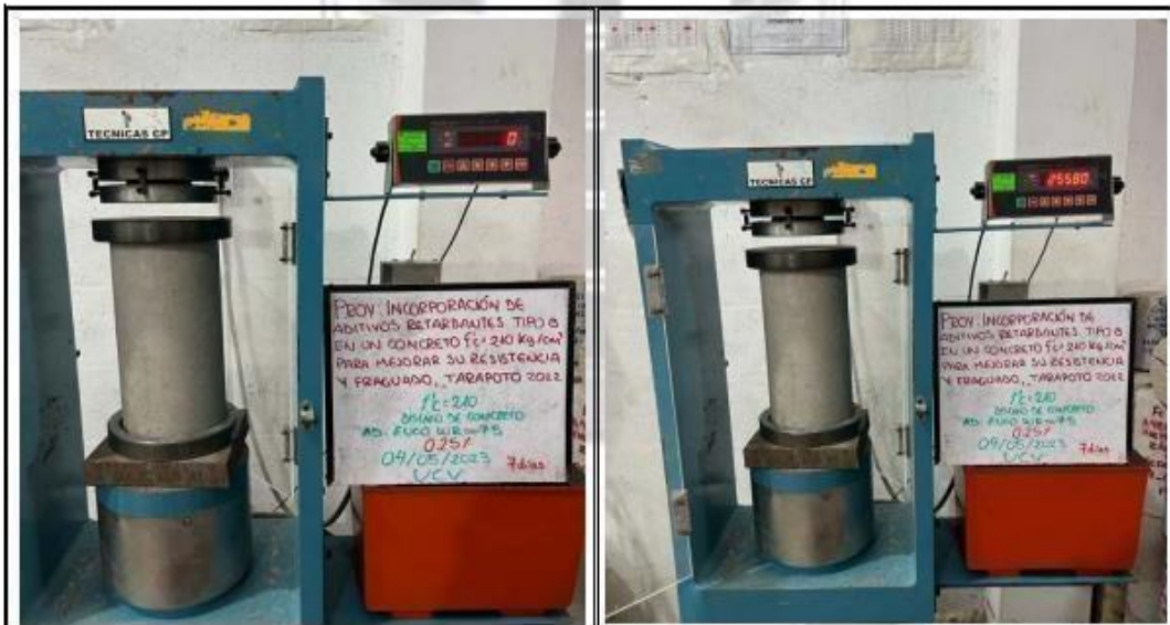
Fotos nº 39-40: En las imágenes podemos observar la resistencia a la compresión axial de los testigos de concreto
