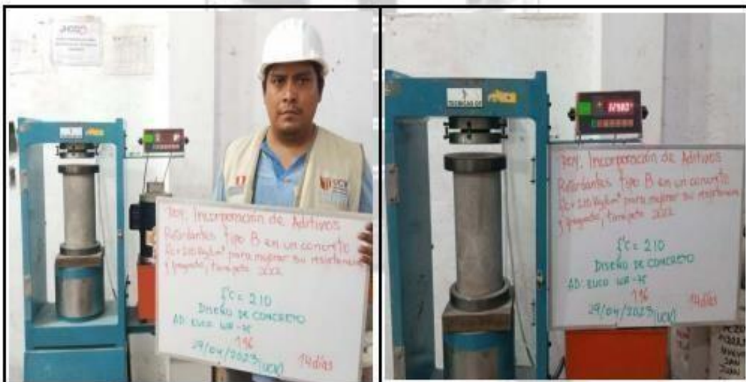
Fotos nº 79-80: En las imágenes podemos observar la resistencia a la compresión axial de los testigos de concreto
