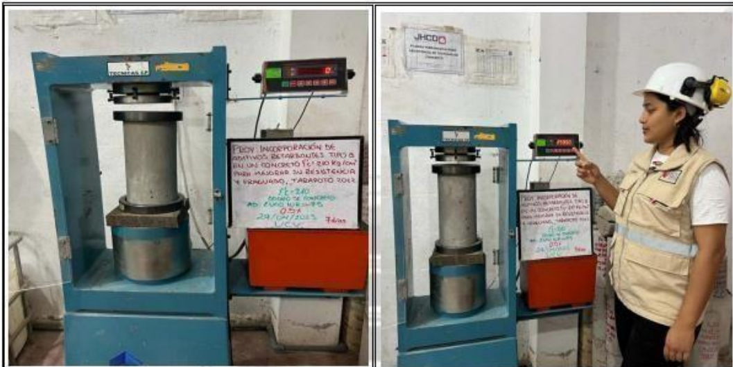
Fotos nº 53-54: En las imágenes podemos observar la resistencia a la compresión axial de los testigos de concreto
