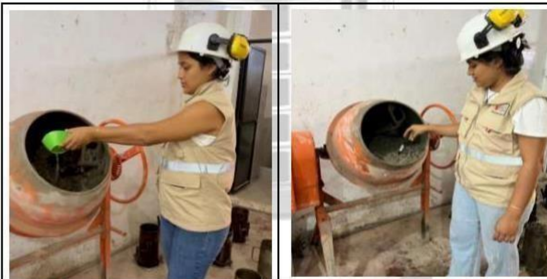
Fotos nº 11-12: En las imágenes podemos observar al personal realizando moldeo de los testigos de los diseños.
