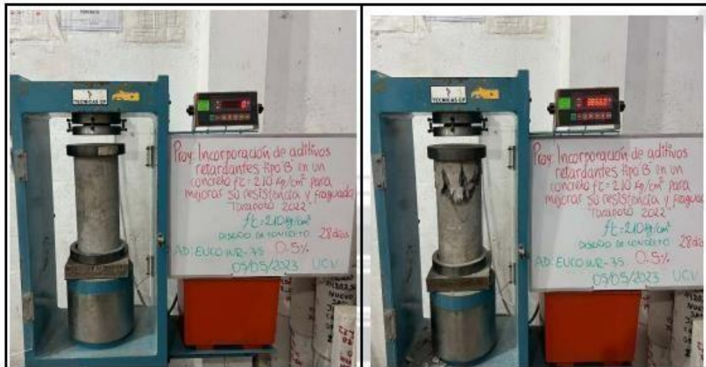
Fotos nº 65-66: En las imágenes podemos observar la resistencia a la compresión axial de los testigos de concreto
