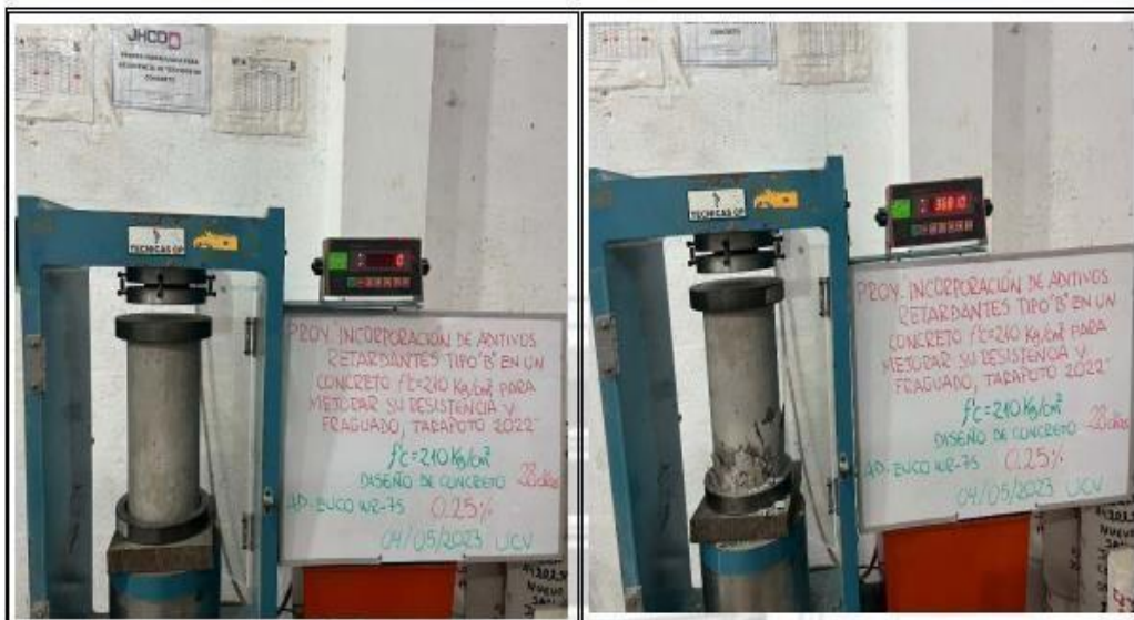
Fotos nº 49-50: En las imágenes podemos observar la resistencia a la compresión axial de los testigos de concreto
