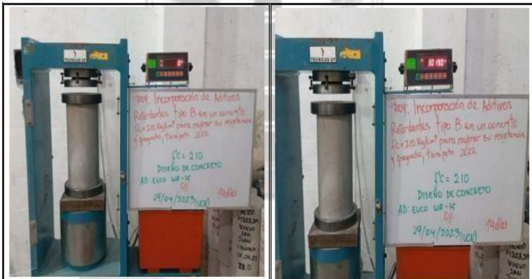
Fotos nº 27-28: En las imágenes podemos observar la resistencia a la compresión axial de los testigos de concreto
