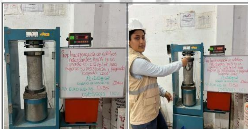
Fotos nº 67-68: En las imágenes podemos observar la resistencia a la compresión axial de los testigos de concreto
