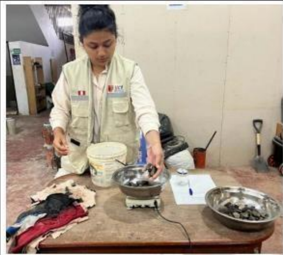
Fotos nº 05-06: En las imágenes podemos observar la realización del ensayo el peso específico
