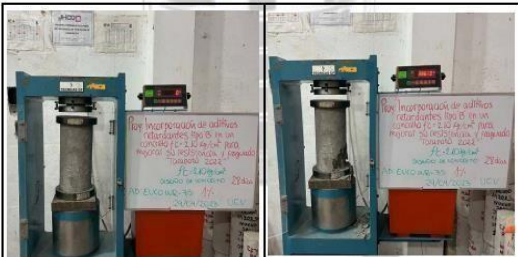
Fotos nº 87-88: En las imágenes podemos observar la resistencia a la compresión axial de los testigos de concreto
