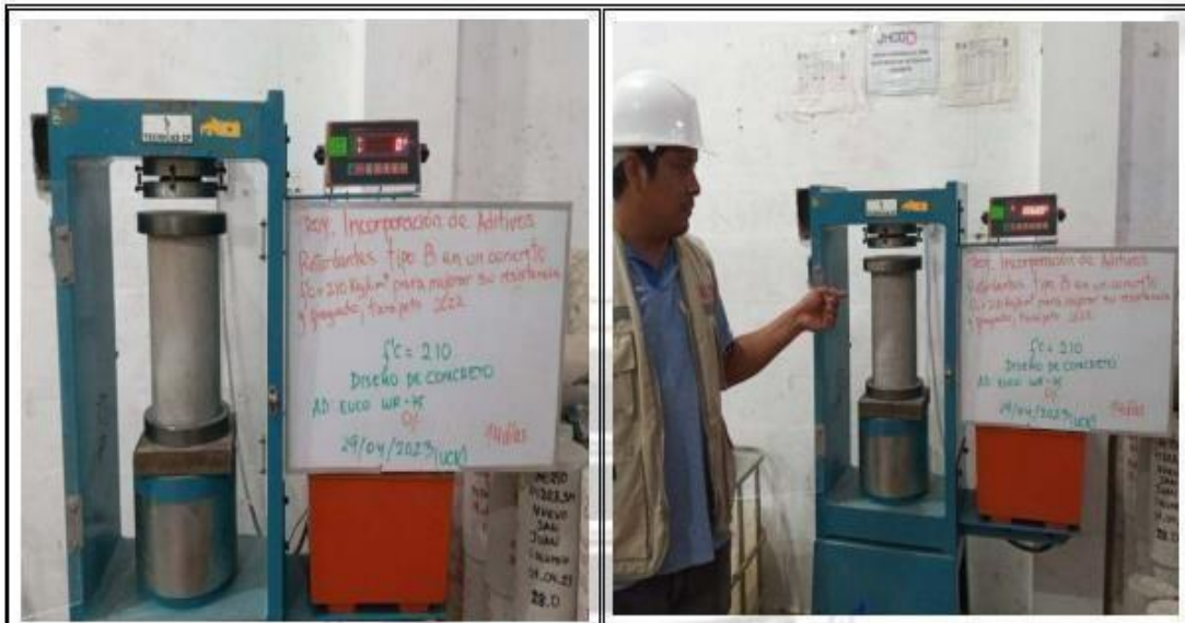
Fotos nº 25-26: En las imágenes podemos observar la resistencia a la compresión axial de los testigos de concreto
