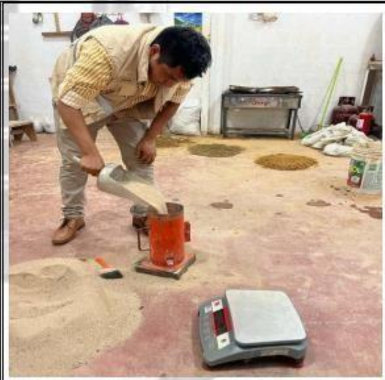
Fotos nº 07-08: En las imágenes podemos observar realización del ensayo de peso unitario.
