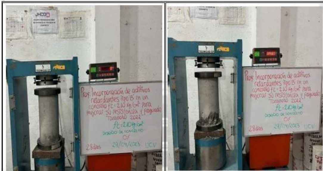
Fotos nº 29-30: En las imágenes podemos observar la resistencia a la compresión axial de los testigos de concreto
