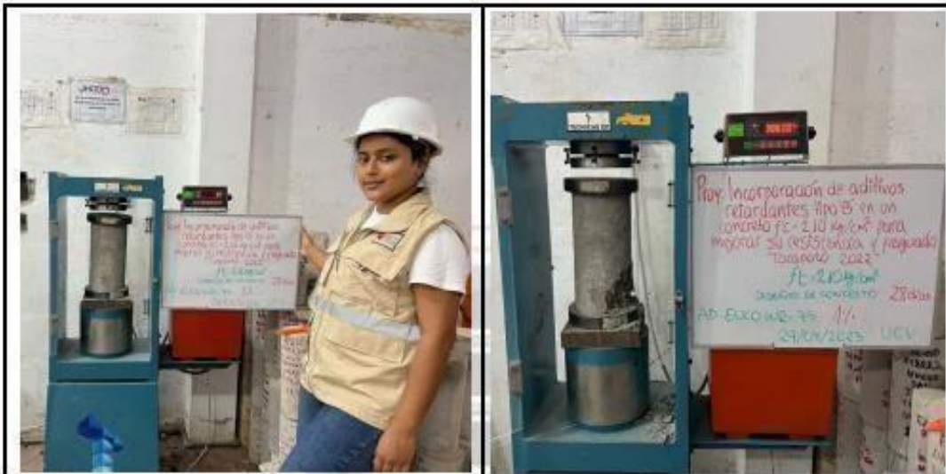
Fotos nº 85-86: En las imágenes podemos observar la resistencia a la compresión axial de los testigos de concreto
