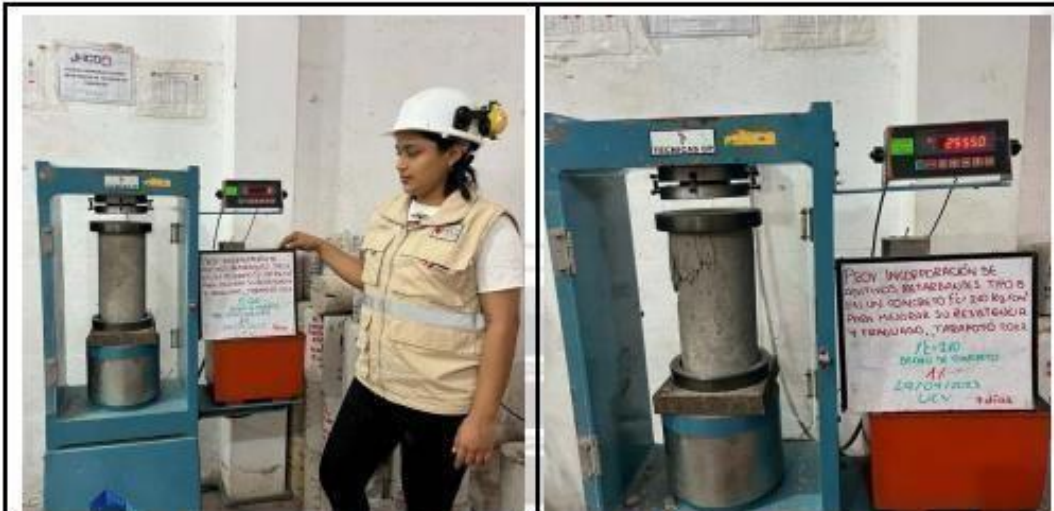
Fotos nº 73-74: En las imágenes podemos observar la resistencia a la compresión axial de los testigos de concreto
