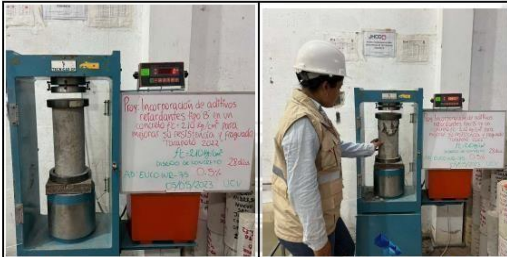
Fotos nº 69-70: En las imágenes podemos observar la resistencia a la compresión axial de los testigos de concreto
