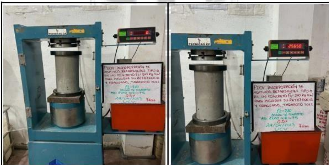
Fotos nº 55-56: En las imágenes podemos observar la resistencia a la compresión axial de los testigos de concreto
