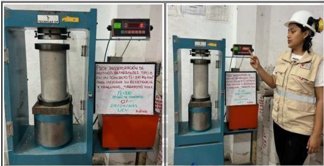
Fotos nº 21-22: En las imágenes podemos observar la resistencia a la compresión axial de los testigos de concreto
