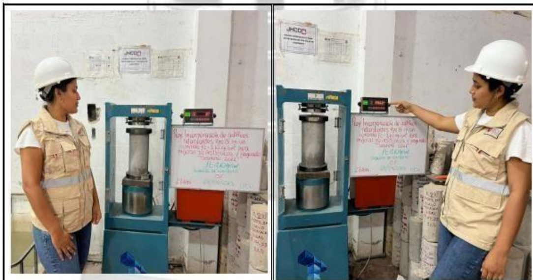
Fotos nº 31-32: En las imágenes podemos observar la resistencia a la compresión axial de los testigos de concreto
