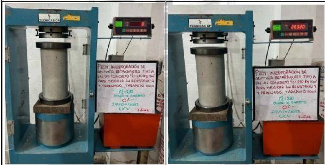
Fotos nº 19-20: En las imágenes podemos observar la resistencia a la compresión axial de los testigos de concreto
