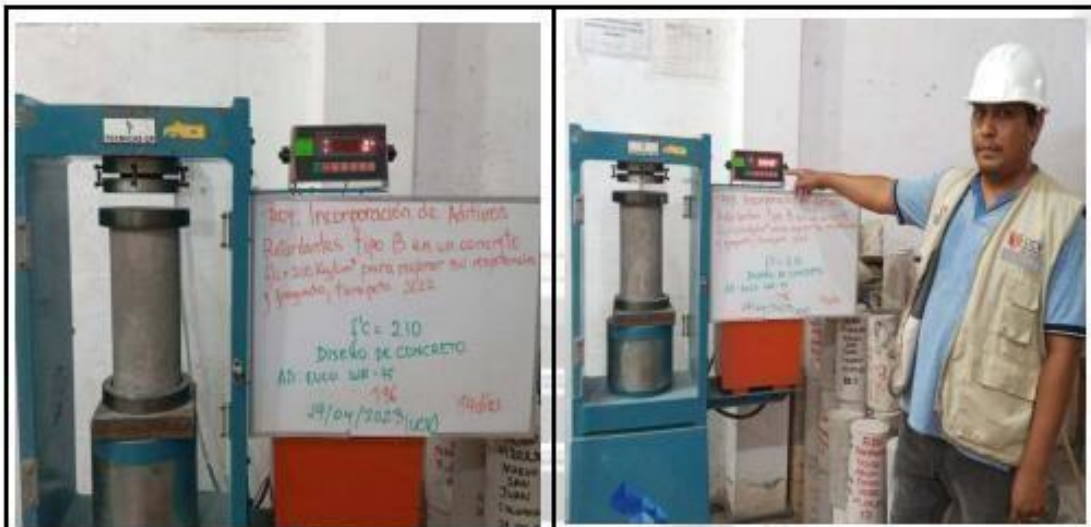
Fotos nº 81-82: En las imágenes podemos observar la resistencia a la compresión axial de los testigos de concreto
