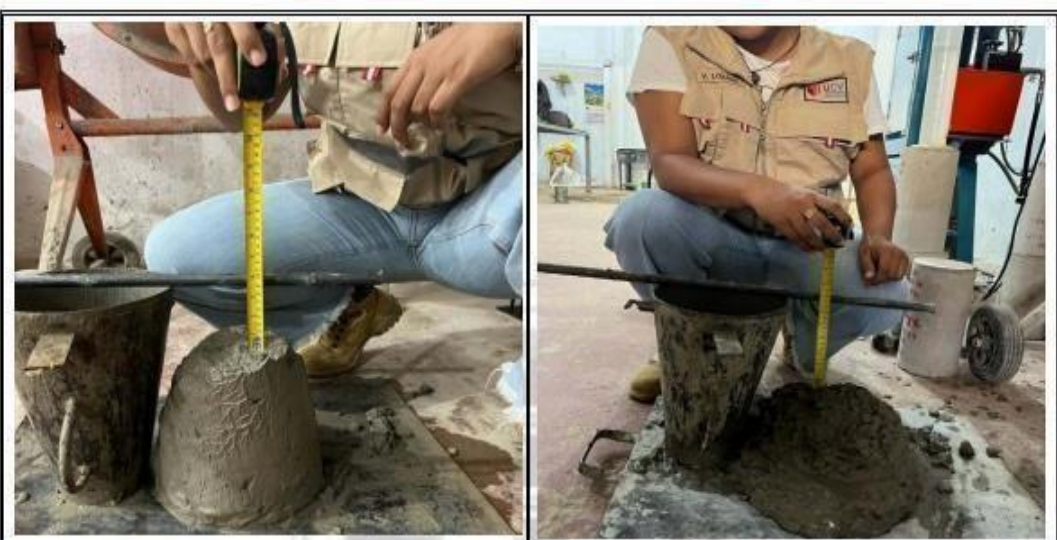
Fotos nº 13-14: En las imágenes podemos observar al personal realizando la prueba de asentamiento para los diseños de Mezclas.
