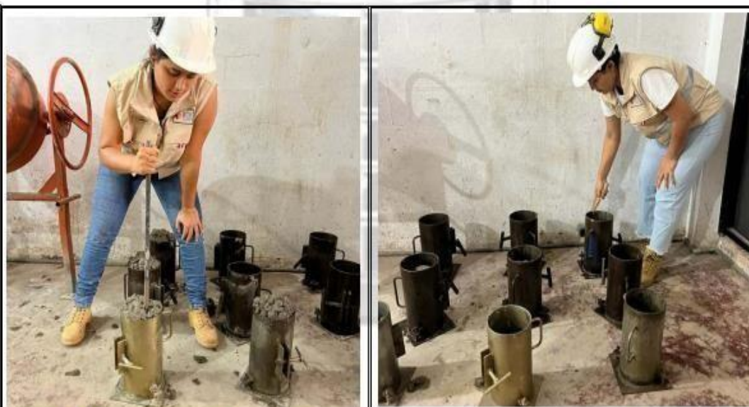
Fotos nº 15-16: En las imágenes podemos observar al personal realizando el moldeo de los testigos de concreto.
