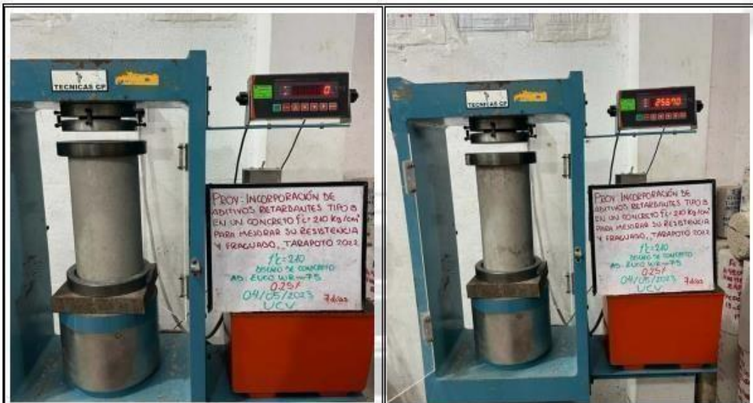
Fotos nº 37-38: En las imágenes podemos observar la resistencia a la compresión axial de los testigos de concreto
