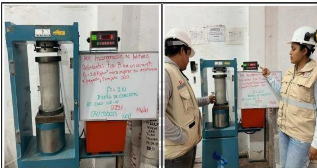
Fotos nº 45-46: En las imágenes podemos observar la resistencia a la compresión axial de los testigos de concreto
