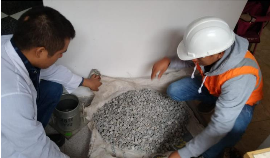
Figura 26 Material de piedra chancada de diámetro \frac{3}{4} Fuente: Elaboración propia
