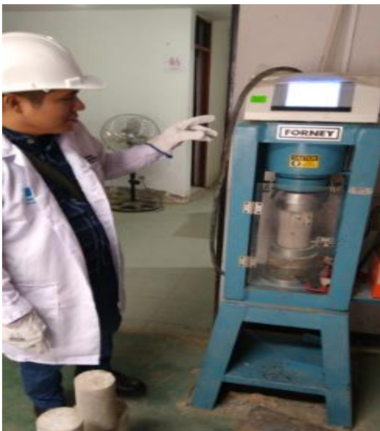
Figura 37 Rotura en la prensa hidráulica
