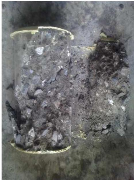
**5.1.2.1 Resistencia a la compresión.** La resistencia a compresión simple del concreto es la capacidad del mismo para resistir esfuerzos de compresión y constituye una de sus propiedades más importantes, debido a que a partir de ella son evaluadas otras características mecánicas.
