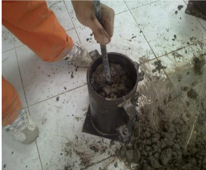
Figura 43. Vibrado de la capa compactado
