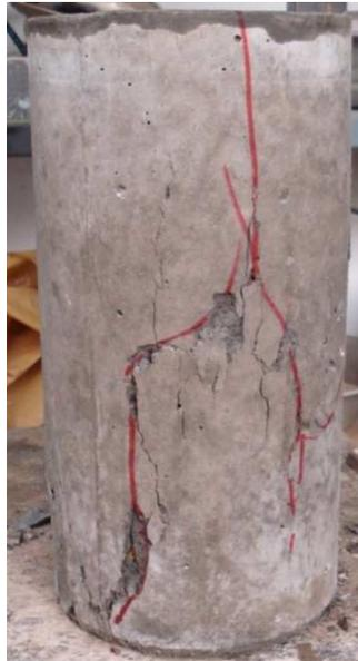
Como se puede observar en la imagen la falla de los cilindros de concreto fue en forma de cono y rotura vertical; presentando primero una falla vertical y luego desprendiéndose de ella dos planos inclinados, esto hace evidenciar que el ensayo de compresión de cilindros se realizó de la forma correcta, aplicando una carga sobre la superficie superior del cilindro a una velocidad especificada mientras ocurre la falla.
