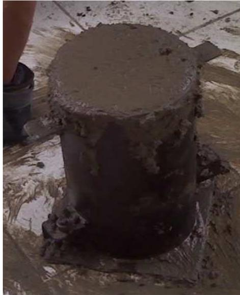
Figura 45. Afinado del cilindro terminado
