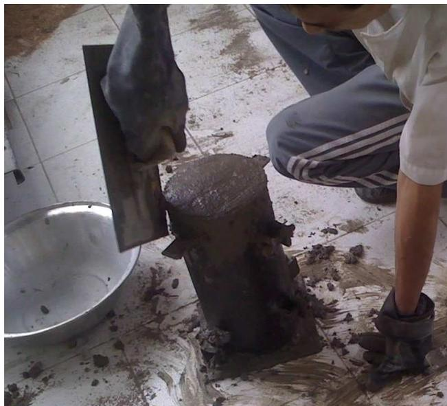
Figura 46. Cilindros terminados
