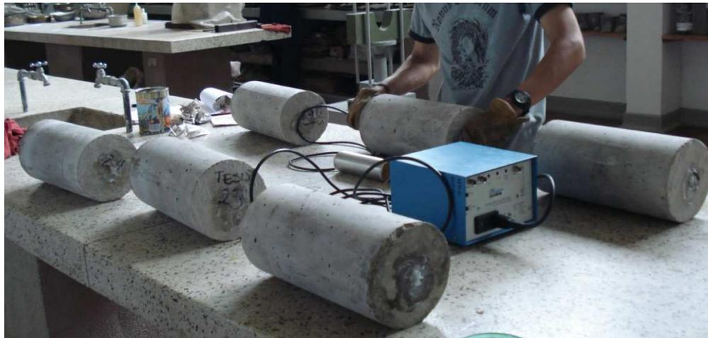
Este ensayo es un método no destructivo, el cual consiste en la medición del tiempo en que un pulso ultrasónico de vibración longitudinal atraviesa el concreto, se usa para determinar la uniformidad del concreto, para medir y detectar agrietamientos, así como los vacíos y otros defectos del concreto, para medir los cambios en las propiedades del concreto a través del tiempo, además de medir el deterioro del concreto ocasionado por el fuego, y realizar.
