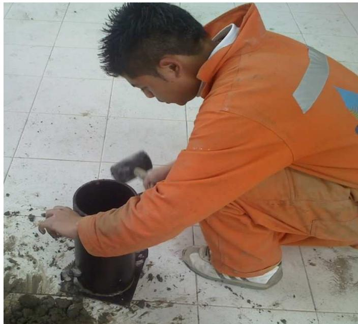
Figura 44. Finalización del proceso de compactación y vibrado
