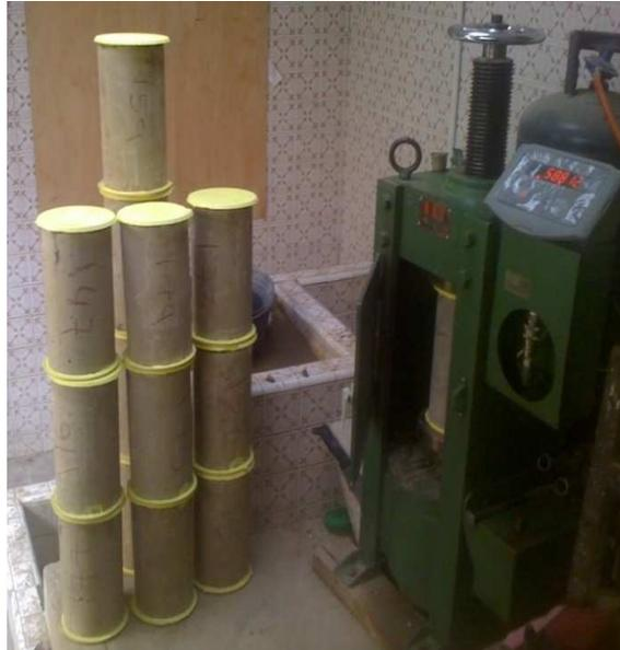
Posteriormente de ese procedimiento, se realiza el ensayo a compresión simple según la norma NTC 673 (ENSAYO DE RESISTENCIA A LA COMPRESION DE CILINDROS NORMALES DE CONCRETO).
