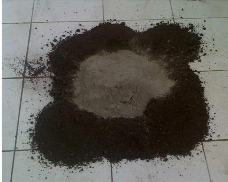
Figura 36. Homogenización cemento y agregado fino
