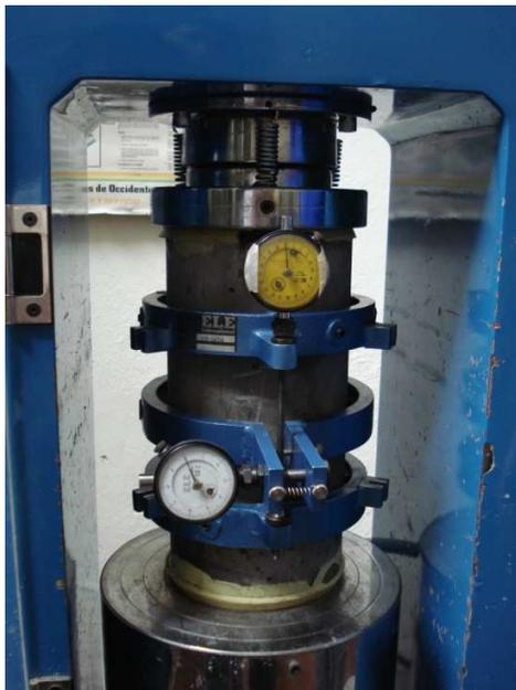
Se define el módulo de elasticidad estático del concreto como la pendiente de la parte inicial de la curva esfuerzo-deformación unitaria del concreto y aumenta con la resistencia del concreto a compresión simple. Para su determinación se emplea el denominado *módulo secante*, que se obtiene de la pendiente de la recta que une el origen de la curva de esfuerzos vs deformación unitaria del concreto, con un punto correspondiente a un esfuerzo de  $0,45 f'c$ .
