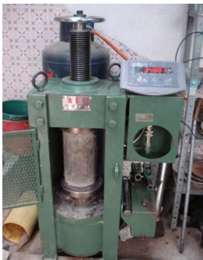
Tabla 48 Resistencia a la compresión de los concretos con relación a/c 0,45. Para una resistencia especificada (2500-3000) Psi.
