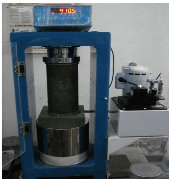
Figura 50. Cilindro después del ensayo de resistencia a la compresión simple
