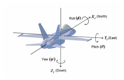
Em seguida, uma rotação (arremesso) em torno de ângulo do eixo  $y_2(Pitch)$ , em que movimenta o nariz da aeronave para cima ou para baixo, criando novamente um novo sistema referencial  $\mathbf{x}_3 = \mathbf{T}_{32}\mathbf{x}_2 = Q_2\mathbf{x}_2Q_2'$ . Sua representação na forma de matriz e quatérnios são respectivamente
