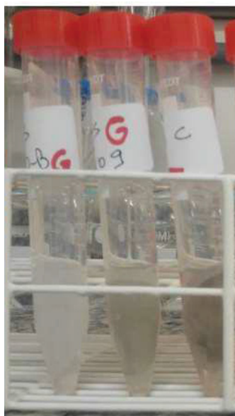
FIGURA 9 - AMOSTRAS DE MP 2,5 INSERIDAS EM TUBOS TIPO FALCON UTILIZADOS NO ENSAIO IN VITRO DE BIOACESSIBILIDADE COM FLUIDO ALF
