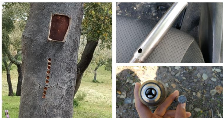
Figura 16- Esquerda: Exemplo dos sobreiros onde as amostras de cortiça foram recolhidas. Direita: instrumento utilizado para a recolha de amostras de cortiça.
