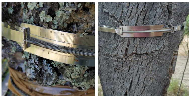
Figura 15- Sobreiros de Vila Viçosa e Coruche, com dendrómetros instalados.
