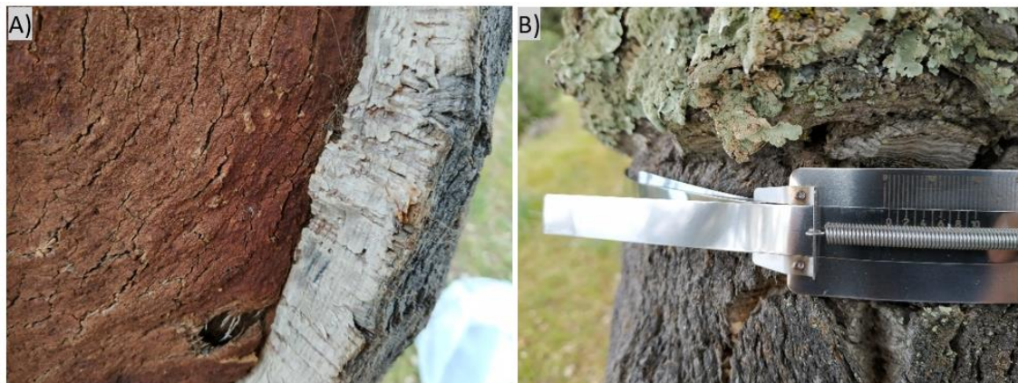
Figura 3- A) Sobreiro onde foi retirado uma cala e é possível ver o lenho e a cortiça da árvore. B) Sobreiro com dendrómetro de banda instalado para medir o crescimento radial da árvore.
