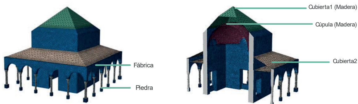
Figura 3. Modelo de elementos finitos del Cenador de Carlos V y especificación de materiales.
