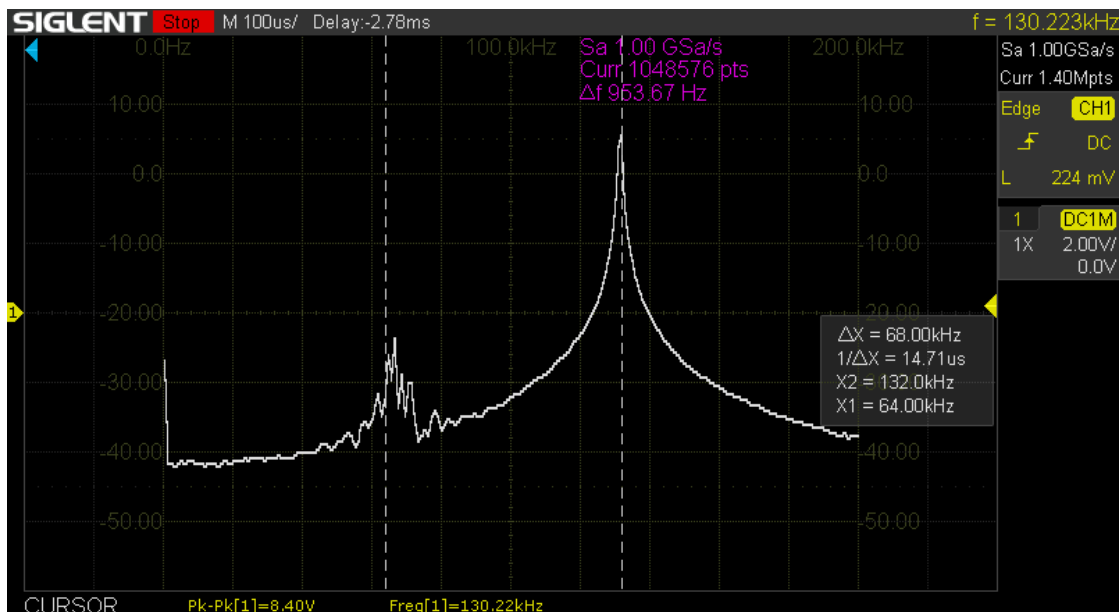
Figura 4.3.8: Espectro de la señal medida en la antena sensora. Se distingue la componente fundamental de 131 kHz y una componente más débil de 64 kHz.
