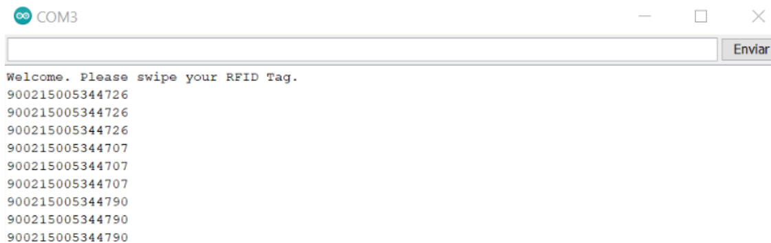
Figura 4.3.6: Lecturas de los transpondedores FDX-B en el terminal de Arduino.
