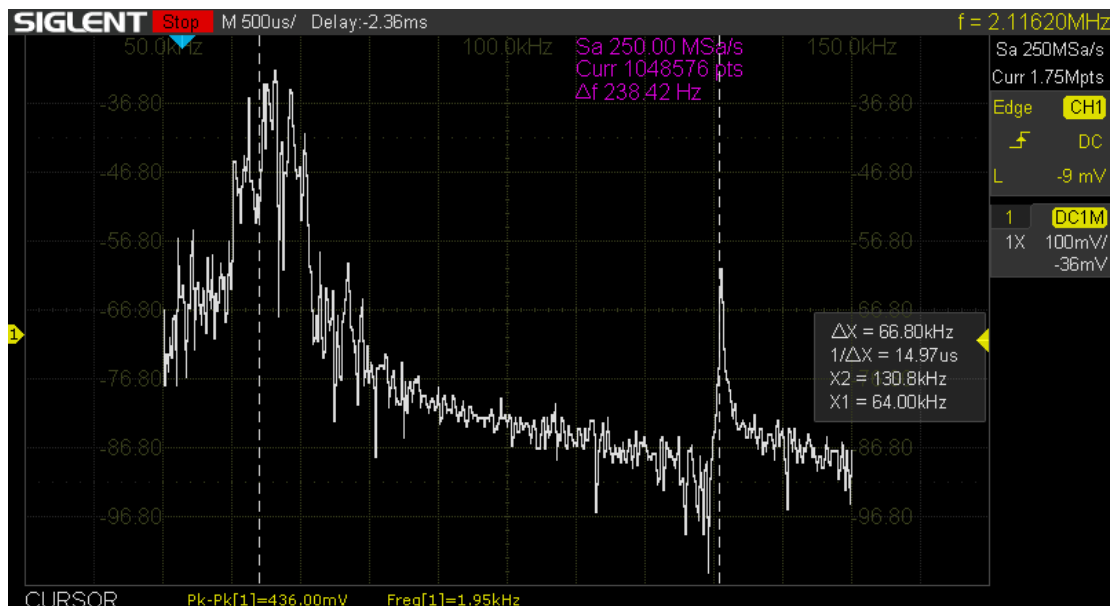
Figura 4.3.10: Señal en el dominio de la frecuencia obtenida después de un exhaustivo filtrado paso-bajo.
