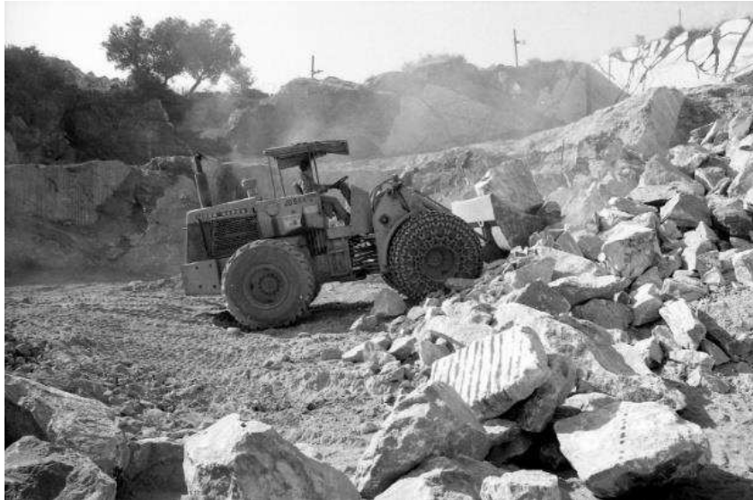
Figure 29 : Tracteur enlevant les blocs de marbre, carrière Viana do Alentejo, XXème siècle (source : archives CECHAP, P0352)
