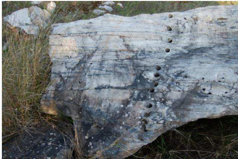
Figure 10 : Bloc possédant encore les traces de cales, Borba – S. Tiago Rio de Moinhos – Pedreira da Ruivina (source : archives du CECHAP, P0059)
