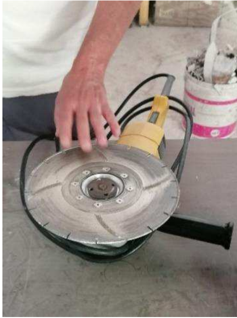
Figure 40 : Outil mécanique pour la sculpture du marbre (source : Julie Prévost, photo personnelle, octobre 2022)
