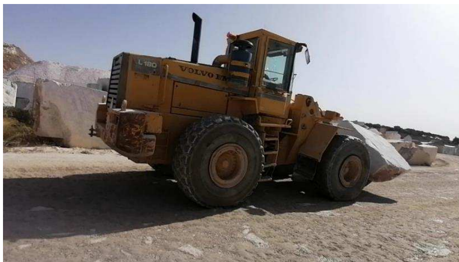
Figure 35 : Transport d'un bloc de marbre dans les carrières Galrão, Portugal (source : Julie Prévost, photographie personnelle, octobre 2022)
