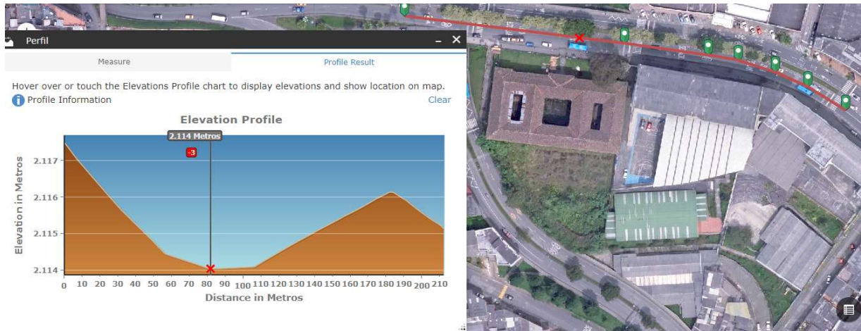
Ilustración 15: Estudio de instalación de un resalto, pendiente longitudinal sentido Occidente- Oriente “Fundadores a El Cable”
