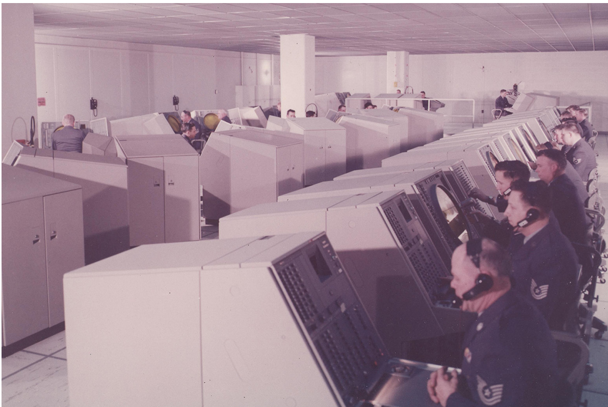
Fig. 28 Centro de controlo do sistema SAGE - Um hub central que recebia informações de radares e enviava notificações contínuas sobre alvos descobertos para centenas de aeródromos e bases militares.
