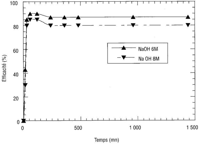
**Figure 3** Effet de la concentration de la soude sur la désorption des fluorures.
