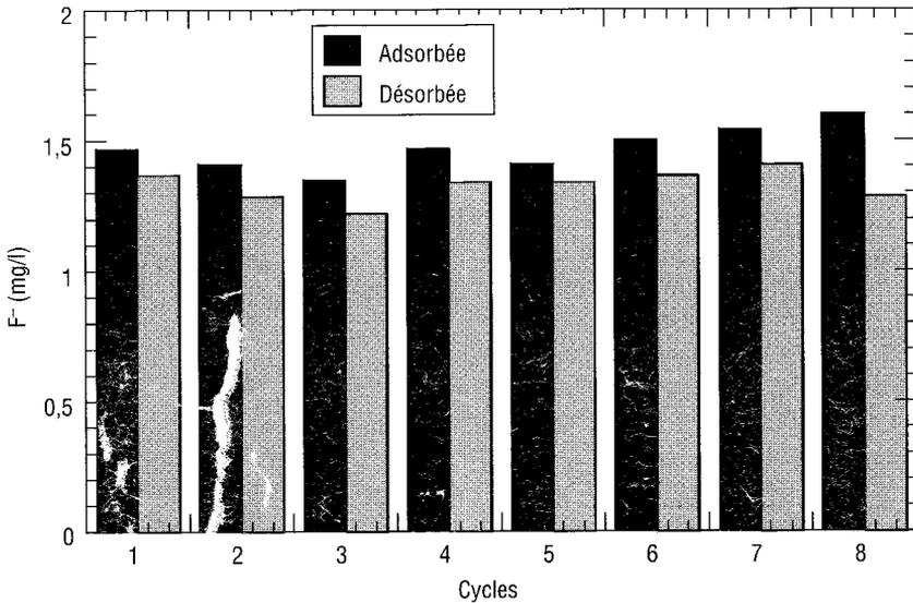
**Figure 4** Quantité des fluorures adsorbée et désorbée au cours des 8 cycles d'adsorption-désorption.
