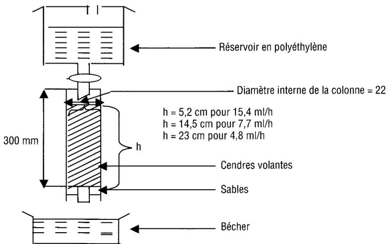
**Figure 1** Schéma du montage utilisé pour la défluoruration des eaux d'exhaure en colonne.
