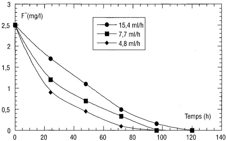
**Figure 2** Résultats de la défluoruration sur colonne pour les différentes charges hydrauliques.
