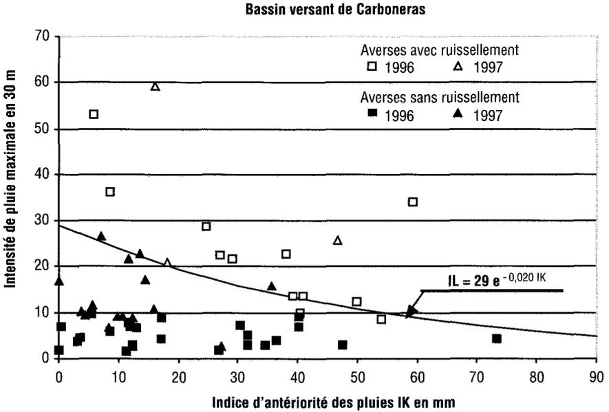
**Figure 3** Détermination de l'intensité de pluie limite du ruissellement ( $IL$ ) sur le bassin versant de Carboneras (ESTRADA AVALOS, 1999).
