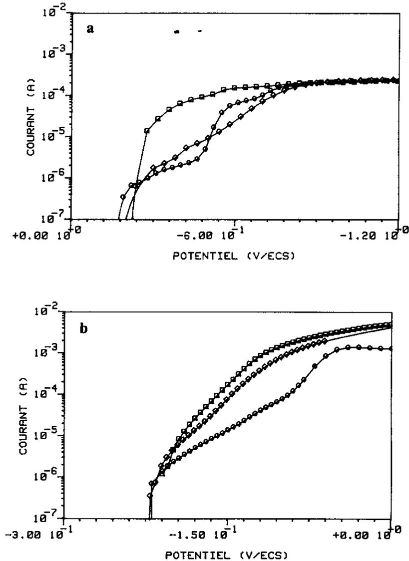
**Figure 4** Idem figure 3 après 17 heures d'immersion au potentiel de corrosion.
