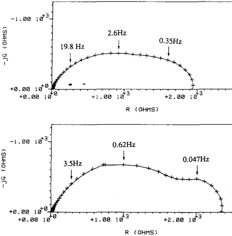
**Figure 2** Diagrammes d'impédance électrochimique obtenus au potentiel de corrosion en l'absence d'inhibiteur après 2 heures (a) et 17 heures (b) d'immersion.  $S = 0,32 \text{ cm}^2$ .
