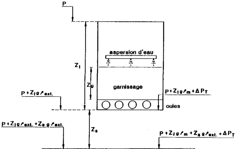
Figure 3 Equilibre des pressions à l'intérieur et à l'extérieur du lit bactérien
