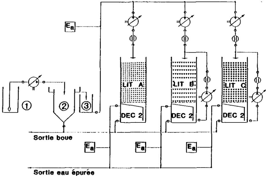
Figure 1 Schéma de principe de l'installation pilote.
