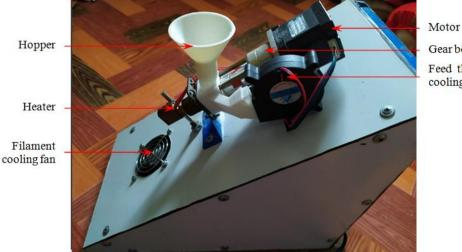
Gear box Feed throat cooling fan
