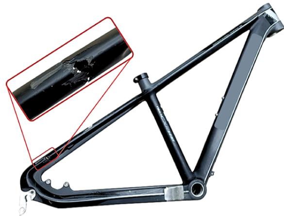
Figura 1. Falla en vainas superiores
