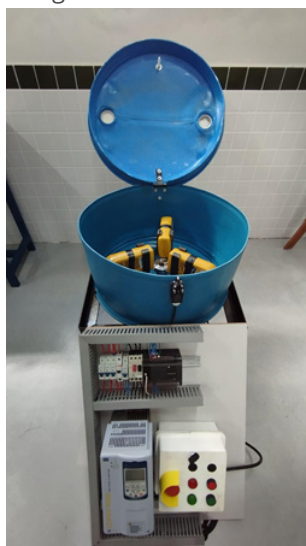
Figura 10 - Protótipo da centrífuga proposta para drenagem do óleo lubrificante.
