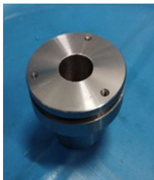
Figura 5 - Flange para conexão dos suportes ao eixo do motor.
