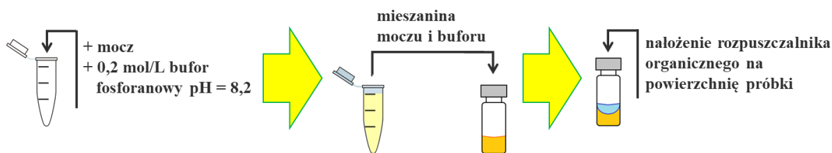
Rys. 44. Schemat przygotowania próbki moczu do procedury SDME.
