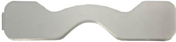
Figura 21. Probeta de silicón para prueba mecánica de desgarre realizada con moldes de aluminio.
