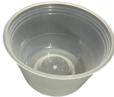
**Figura 13. Molde utilizado para fabricar muestras de silicona.**
