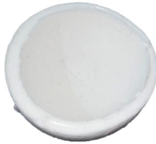
**Figura 27. Recubrimiento de silicona sin el metamaterial.**
