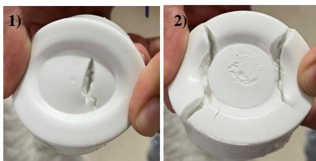
**Figura 19. Muestras desgarradas al aplicar fuerza. 1) Muestra A y 2) Muestra D.**
