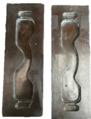
**Figura 20. Moldes para probetas de prueba mecánica de desgarre.**
