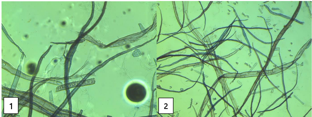
Figura 4.8 - Linha de fibra longa após refinação, (1) sem enzimas ampliado 10x, (2) com enzimas ampliado 4x
