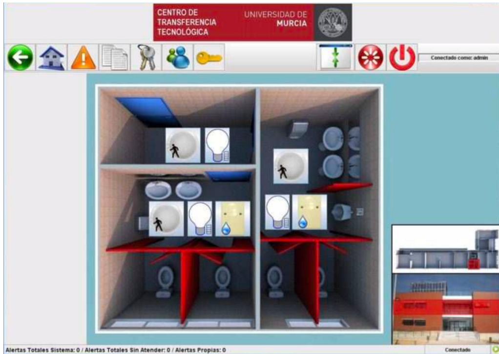
Figura 2.11 - Interface do controlo da luminosidade no edifício. (Fonte: [12])
