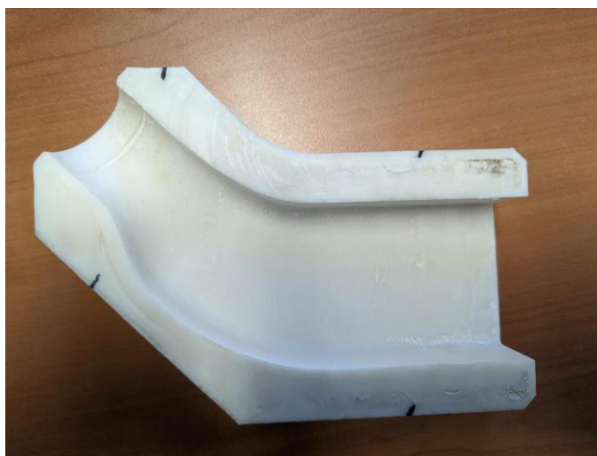
Figura 55 - Molde com material de enchimento maquinado (mostra a parte do infill exposta)
