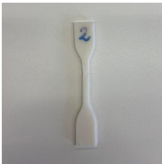
Figura 47 - Provete tracionado do segundo ensaio
