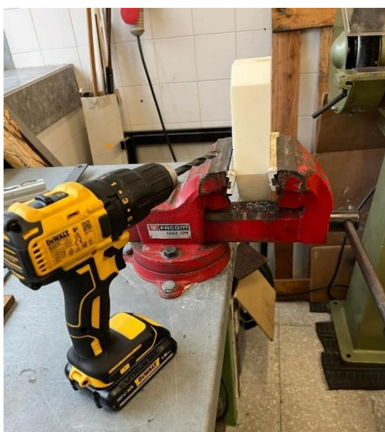
Figura 32 - Perfuração do molde tipo para possibilitar o enchimento do gesso
