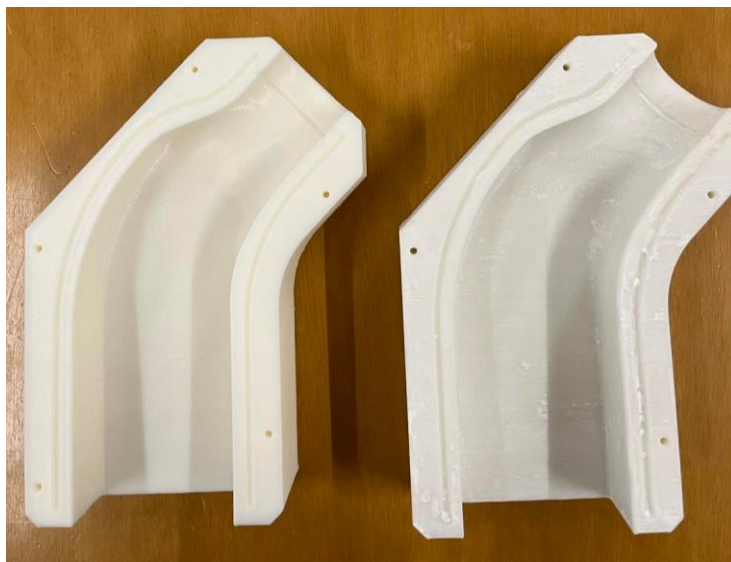
Figura 38 - Molde tipo sem material de enchimento (à esquerda) e molde tipo contendo o gesso de enchimento (à direita)
