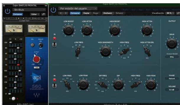
Para la parte trasera se usó solamente el Tube EQ y su configuración fue la siguiente: Se realzo el potenciómetro low boost en 6.6 dB y se atenuó en 0.9 dB, la frecuencia escogida fue la de 60Hz; el potenciómetro high boost donde se pueden realzar frecuencias agudas quedo en 0.9dB con un ancho de banda de 3.9 y se ajustó la frecuencia central de agudos en 6kHz; en el potenciómetro high atten se hizo un corte de agudos en 6.1 dB en los 5kHz.
