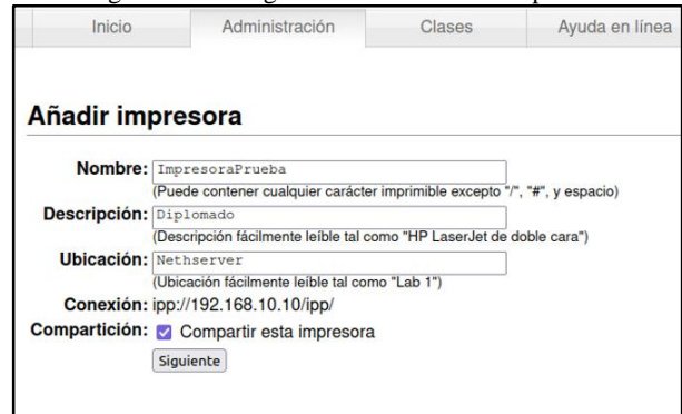
Figura 59. Configuración de la cola de impresión
