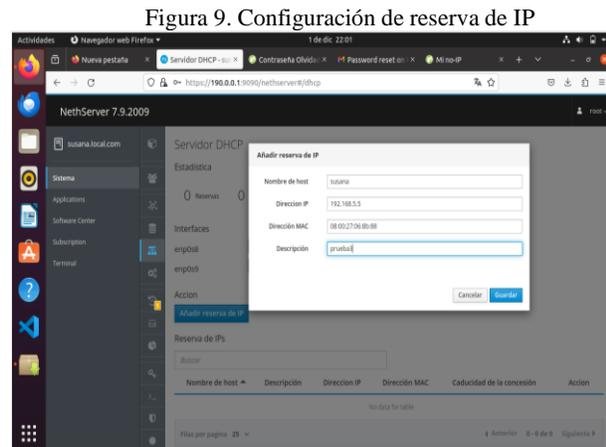
Figura 9. Configuración de reserva de IP
