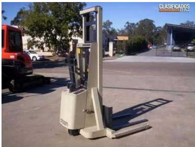
Ilustración 8. Montacarga Eléctrico y Pallet Jack. 27
