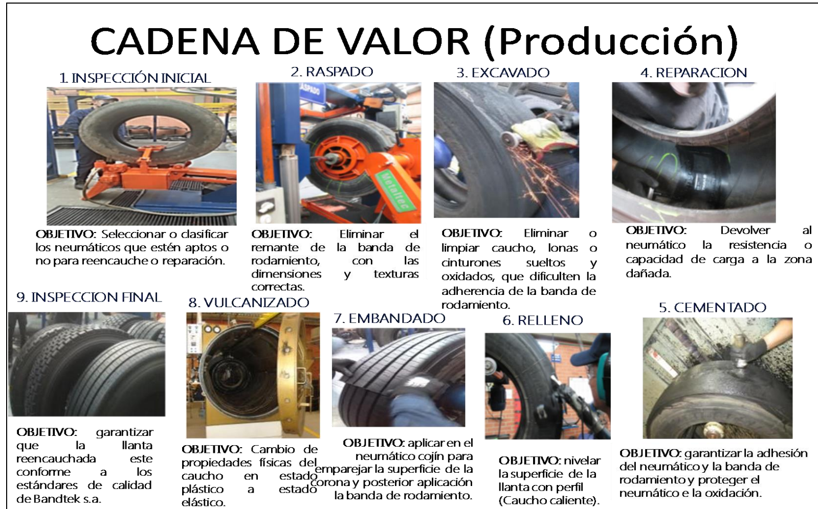
Ilustración 5. Etapas del reencauche de llantas
