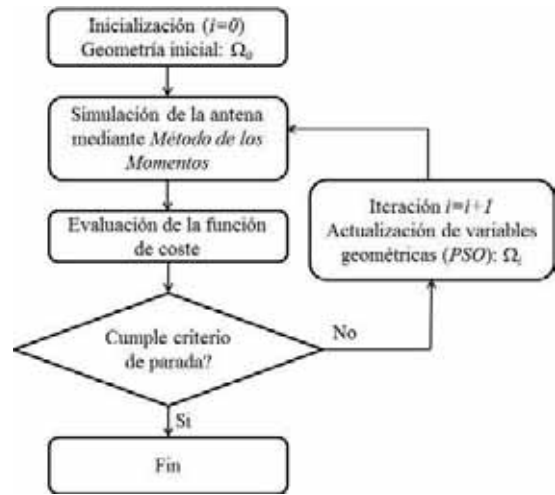
Fig. 1. Diagrama de flujo del método de optimización utilizado. \Omega_i \equiv Conjunto de variables a optimizar en la iteración i -ésima.
