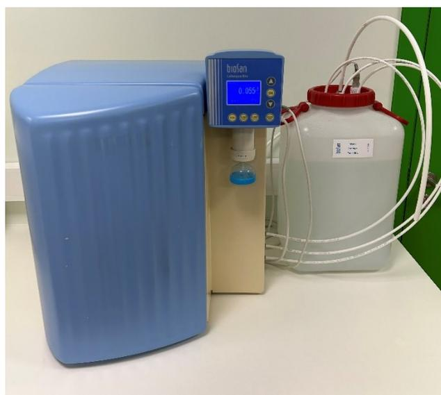
Figura 2.2. Purificador de água corrente em água destilada
