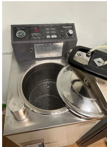
*Figura 2.6. Autoclave – Tratamento térmico das bases*
