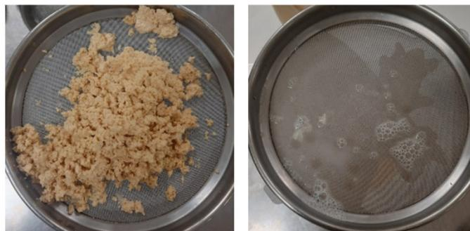
*Figura 2.18. (1) Precipitação da proteína, (2) Não ocorreu precipitação*
