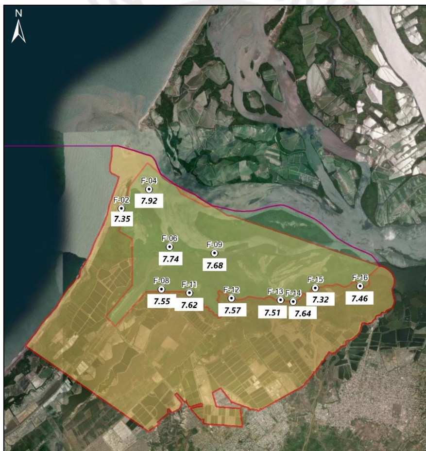
Figura 28. Resultados de pH del agua de estuario realizado en el Santuario Nacional Los Manglares de Tumbes.
