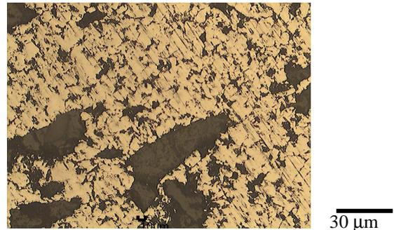
Figura 3: Micrografía de la muestra Ti-20HA sinterizada durante 3 h a 600°C en argón
