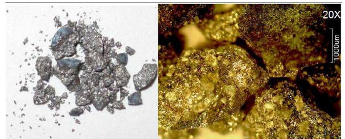
Figura 1: Muestra de Ti-20HA sinterizada a 1200 $^{\circ}\text{C}$  en vacío.
