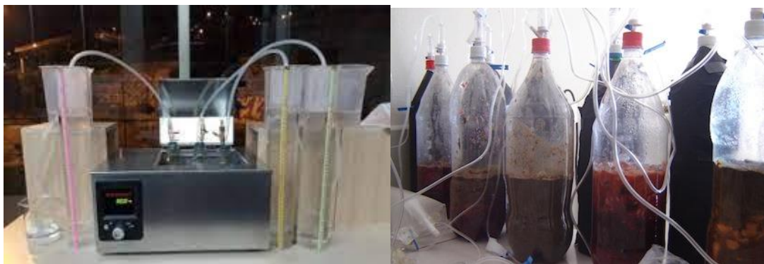
Imagen 8. Biodigestor discontinuo tipo Batch experimental y artesanal.
