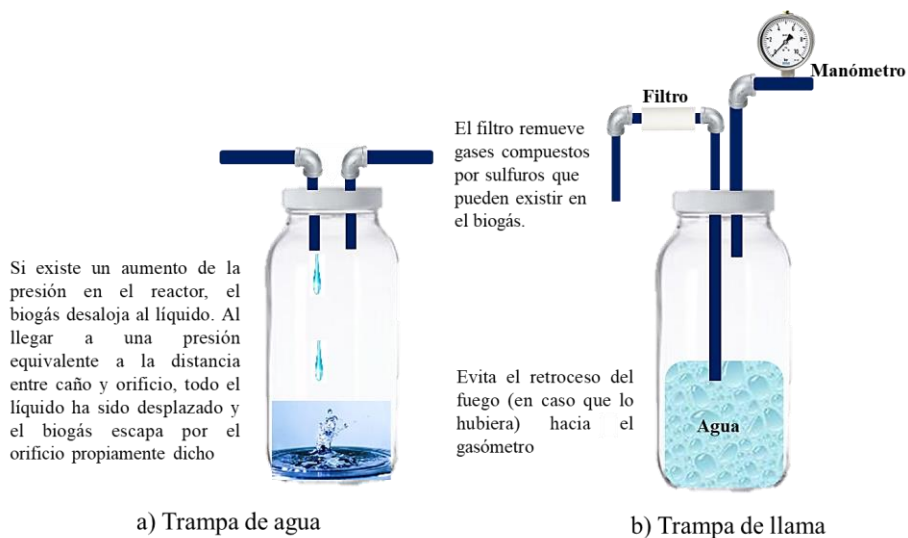
Figura 54. Filtros de seguridad y manómetro para el BAPE
