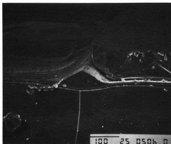
Bild 3. Rasterelektronenmikroskopische Aufnahme eines Probenquerschnitts; die am unteren Bildrand angegebene Strecke beträgt 100 µm. Erkennbar ist die Ablösung bzw. Abschuppung der obersten Gelschicht: rechts liegt sie noch auf, links ist sie bereits nicht mehr vorhanden. (Aufnahme: Sapper, Fachhochschule Coburg.)
