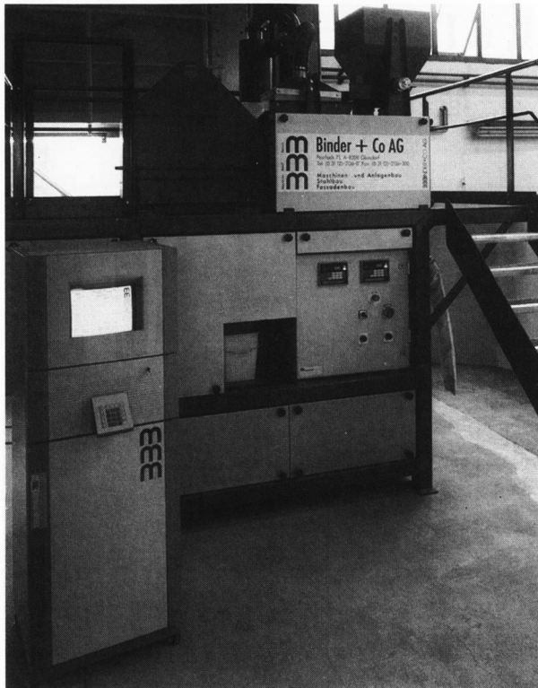
Bild 8. Probenauswertegerät mit dazugehörigem Rechner, Monitor und Protokolldrucker.
