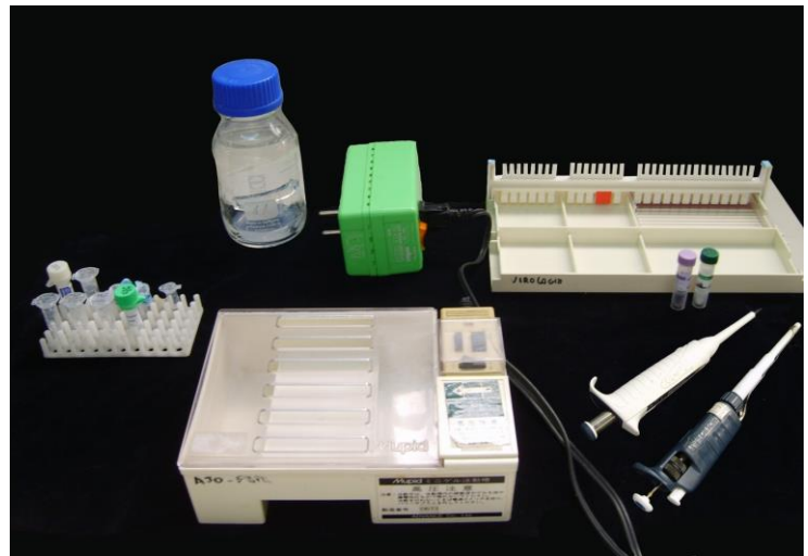
Figura 3. Los productos obtenidos en el PCR, se observan en geles de agarosa teñidos con GelRed para poder visualizarlos (Figura 2). Para ello, se debe sembrar la reacción de PCR en el gel de agarosa y luego se realiza la corrida electroforética en cubas como la que se observa en la foto.
