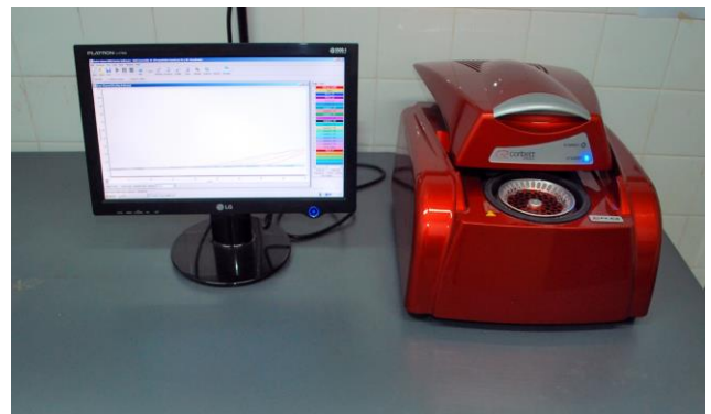
Figura 4. Termociclador en Tiempo Real donde se lleva a cabo la reacción de qPCR. Cuenta con un rotor donde se ubican las muestras a analizar (Tubos de 0,2 mL), un sistema óptico (canales con diferentes longitudes de onda UV a infrarroja) y un software para analizar la reacción.
