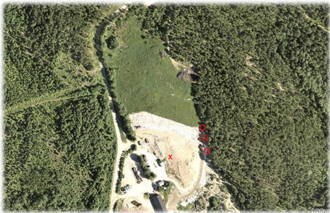
Figur 1. Flyfoto over deponiet på Spillhaug. Kryss viser området hvor det ble målt gass i flukskammer tidligere 2012 og 2013 Dette området er nå dekket til med god vegetasjon. Åpne ringer viser det utsatt området i kantsonen mot skog, hvor måling er blitt utført tidligere, men med mer nøyaktige måleutstyr i 2022 og 2023.
