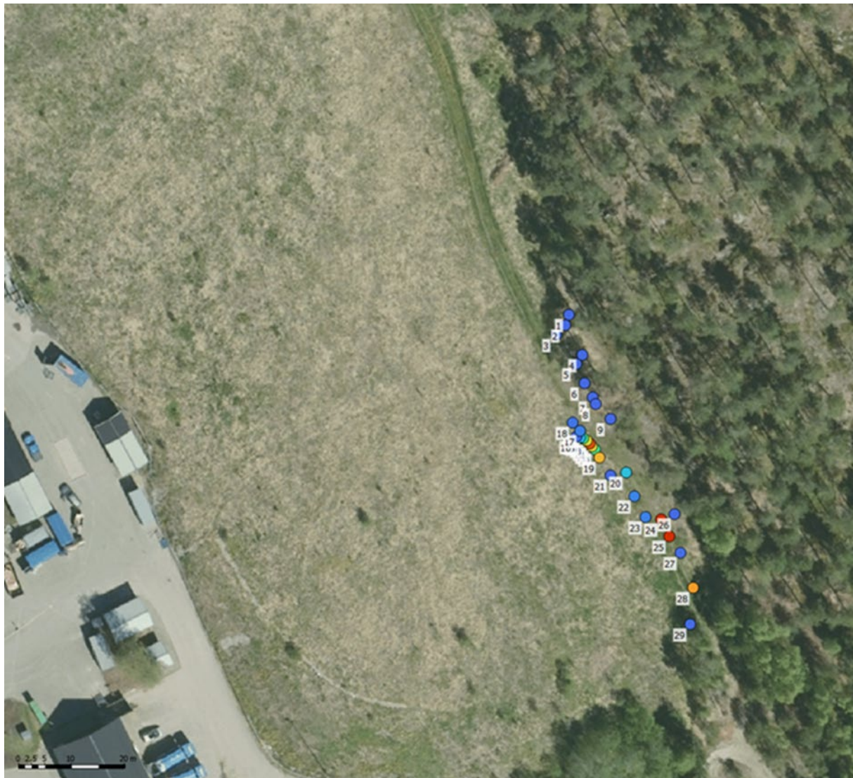
Figur 8a Kart m/ prøvepunkter 05.09.2023, farget etter fluks (enheter nanomol m -2 /sek). «Revehullet» ikke tatt med, men den er mellom pkt 28 og pkt 29. Instrumentet gikk i metning over den (estimert fluks > 500.000 nanomol m -2 /sek. 2022 (mer detaljert i figur 8b).
