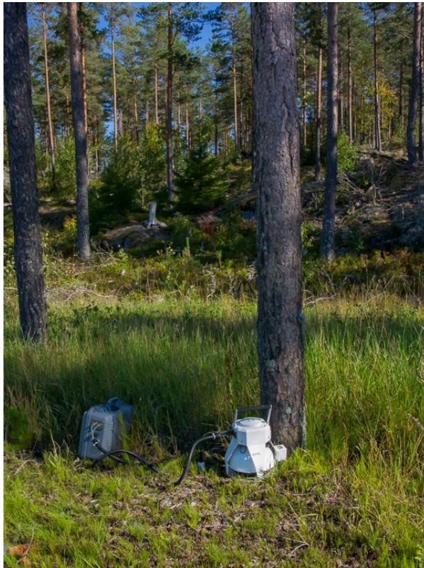
Figur 4. Friske trær ble observert i kantsonen til deponiets nyere del i 2021 (venstre). Det ene var døende høst 2023 (høyre). Ved dette tre ble det påvist emisjon av metangass (under). Dødt tre bør sages ned.
