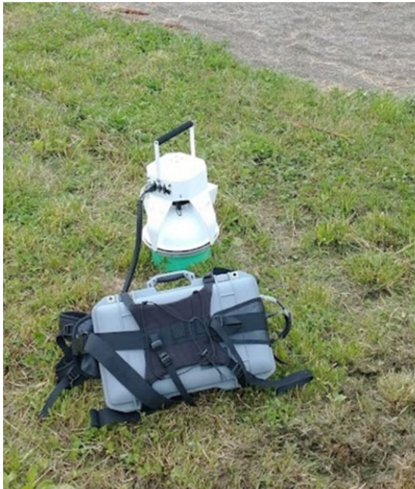
Figur 6: Flukskammer (i hvit) og gassanalysator (grå) brukt til å måle metan og CO 2 emisjon fra overflaten av nedlagt avfallsdeponi.
