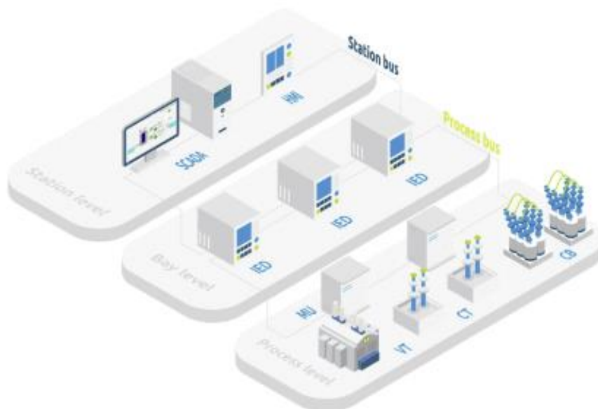
Kuva 2: IEC 61850 -sähköaseman mallin osat [6]
