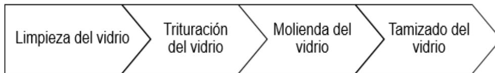
Fig. 2. Proceso para el tratamiento de vidrio para su utilización en el concreto [59].
